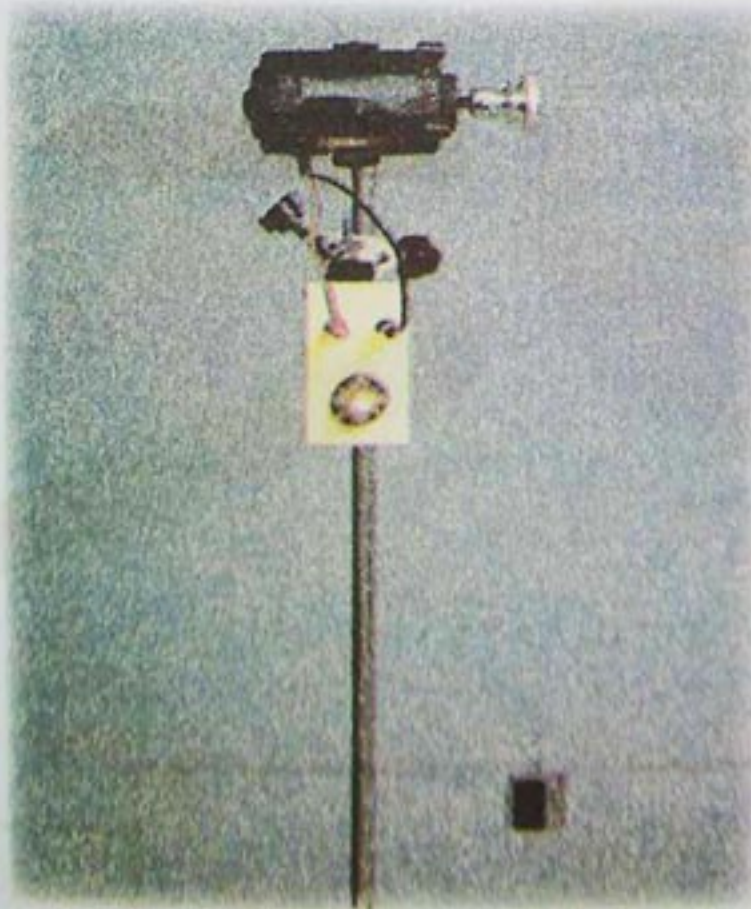
التركيب التجريبي: يشتعل المصباح عند نزول الجسم
