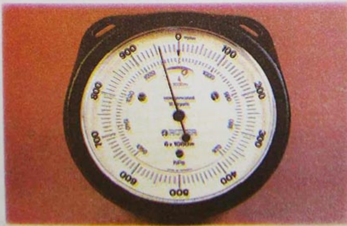
جهاز قياس الارتفاعات، يستعمل عموما في الملاحة الجوية .
